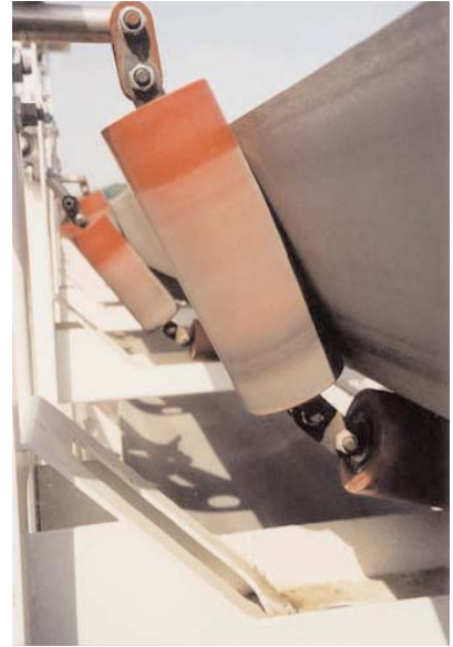
Innovative Tragrollenstühle passen sich den Kurvenradien optimal an
