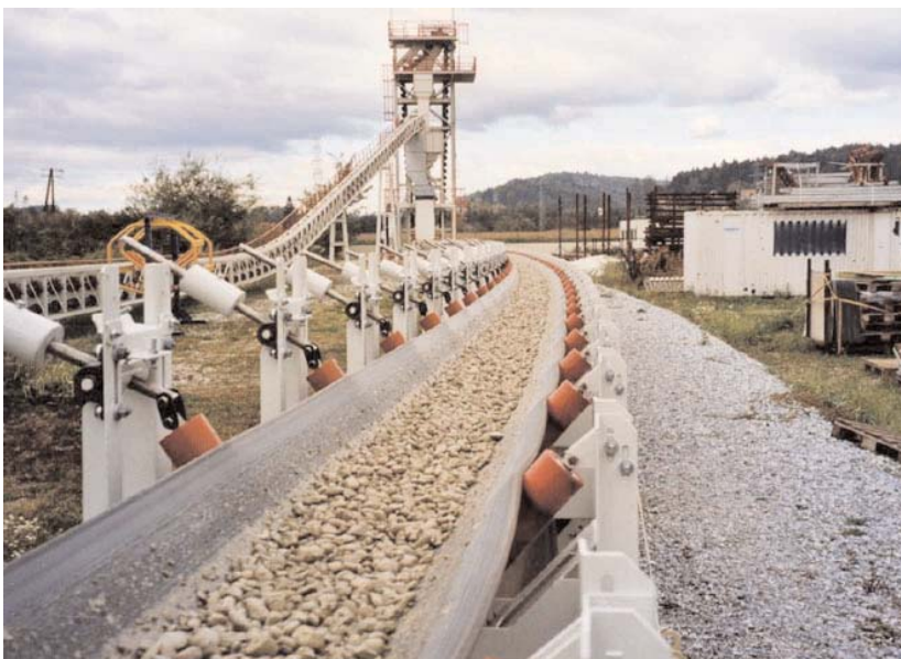
Horizontalkurven sind mit dem neu entwickelten Gurtförderer kein Problem mehr Fotos: Montanuniversität Leoben
