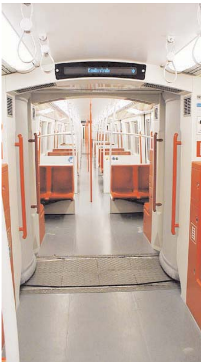
Beim neuen U-Bahn-Wagen gibt es keine getrennten Wagen mehr. Grundeinheit des neuen technischen Konzeptes ist ein durchgehend benutzbares Fahrzeug von run 112 Metern Länge.
