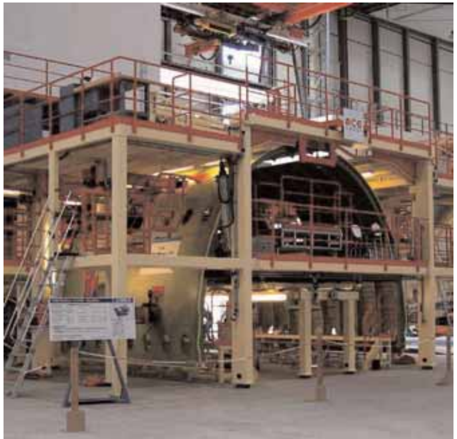
Vorrichtung für den Zusammenbau der oberen Halbschalen für die Rumpfsektion 15
