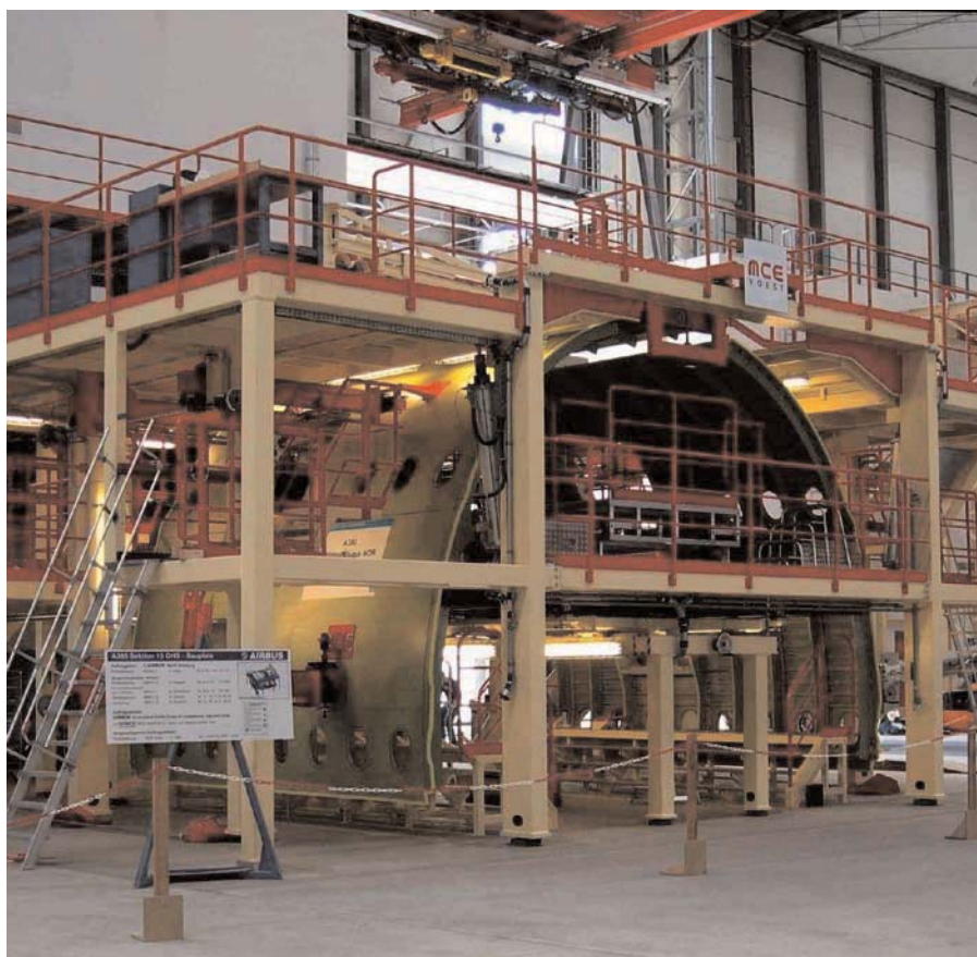
Vorrichtung für den Zusammenbau der oberen Halbschalen für die Rumpfsektion 15
