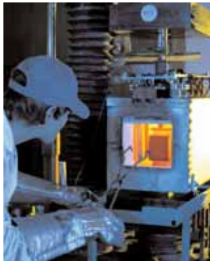
Aus der Praxis: ein Keilspalttest ermöglicht es, die zur Rißausbreitung in einem Werkstoff benötigte spezifische Bruchenergie zu bestimmen
