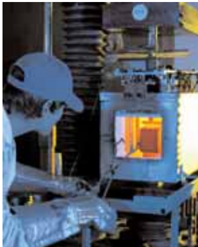
Aus der Praxis: ein Keilspalttest ermöglicht es, die zur Ribausbreitung in einem Werkstoff benötigte spezifische Bruchenergie zu bestimmen
