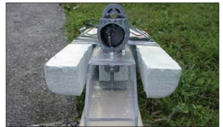
Eine Pumpe als Schiffsantrieb
