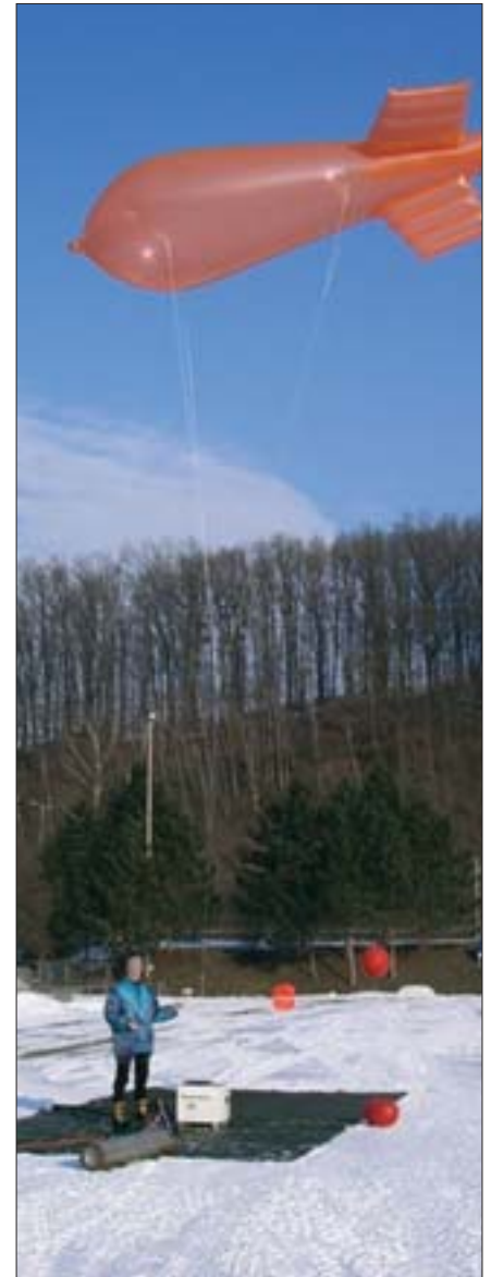
ZAMG-Fesselballon, mit dem – neben einer Vielzahl anderer Geräte – Messungen durchgeführt werden
