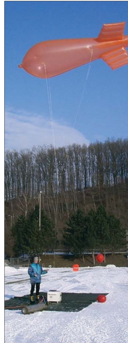
ZAMG-Fesselballon, mit dem – neben einer Vielzahl anderer Geräte – Messungen durchgeführt werden
