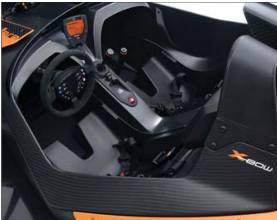
Da die Sitzschalen aus Karbon bestehen und starr mit dem Monocoque verbunden werden, sind die Polsterungen in verschiedenen Größen erhältlich. Eine mechanisch justierbare Pedalerie sorgt im Zusammenspiel damit für perfekte Ergonomie
