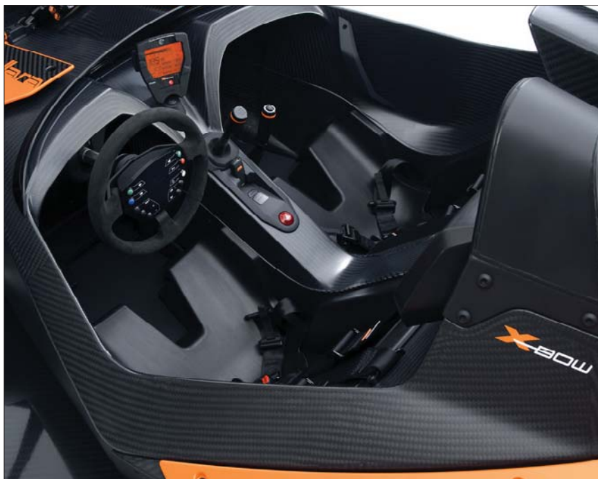
Da die Sitzschalen aus Karbon bestehen und starr mit dem Monocoque verbunden werden, sind die Polsterungen in verschiedenen Größen erhältlich. Eine mechanisch justierbare Pedalerie sorgt im Zusammenspiel damit für perfekte Ergonomie
