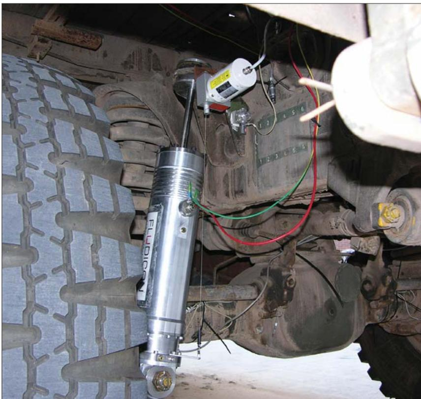
*Verstellbare Stoßdämpfer erhöhen bei geländegängigen Fahrzeugen den Komfort und die Fahrsicherheit. Sie arbeiten mit modernen Regelungsstrategien, die auf mit elektrischer Spannung steuerbaren elektrorheologischen Flüssigkeiten basieren und im Vergleich zu normaler Hydraulik extrem schnell reagieren können.*
