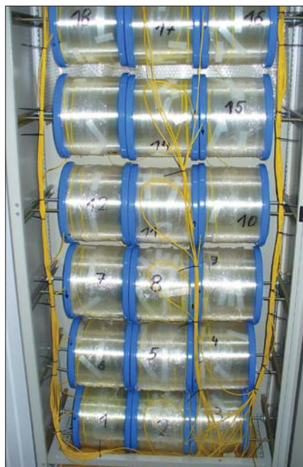
1000 km optische Glasfaser im Institut für Breitbandkommunikation
