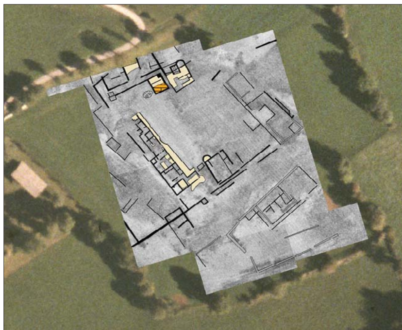
Grundrißplan, erstellt auf Basis der Georadarmessungen auf 14.000 m 2 Wiese
