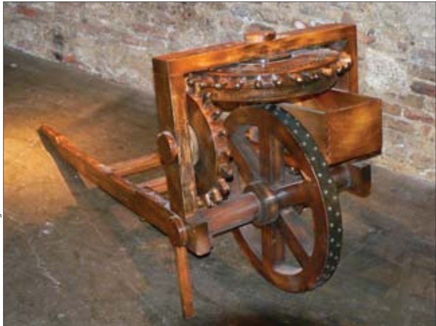
Der »Wegmesser« zeigte anhand »verbrauchter« Kugeln die Wegstrecke an
