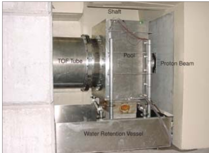
Spallationstarget der n_TOF-Anlage
