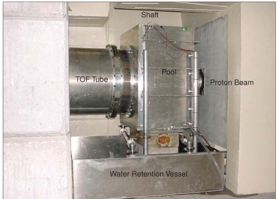
Spallationstarget der  $n_{TOF}$ -Anlage
