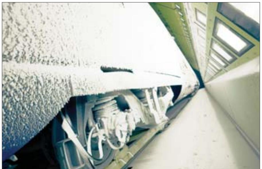
Auch im Unterflurbereich klebt beim Kälte-test der Schnee. Hier sind beim Velaro der Antrieb und alle Technikmodule untergebracht, statt wie bei herkömmlichen Zügen in zwei Lokomotiven vorne und am Ende des Zuges.
