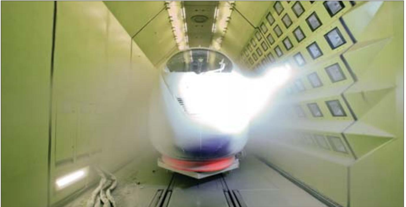
In der Klimakammer der Testanlage Rail Tec Arsenal (RTA) in Wien beweist der Velaro RUS, dass er selbst bei extremer Kälte sicher funktioniert. Beispielhaft erproben das die Siemens-Ingenieure an einem Mittelwagen und am Triebkopf. Im Klima-Wind-Kanal erzeugen sie sogar Blizzards auf Knopfdruck.
