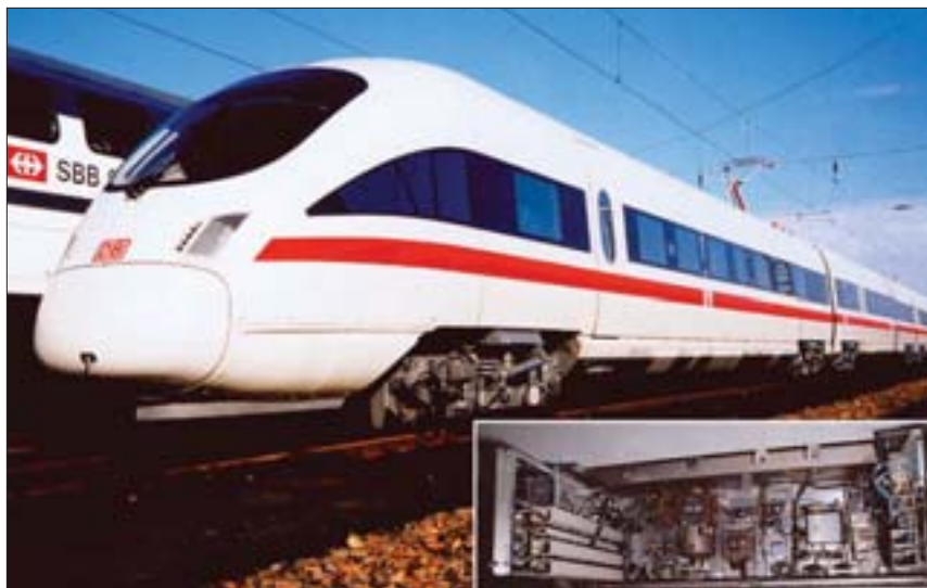
ICE-T mit Bremssteuergeräten in Unterflur-Containerbauweise von Knorr-Bremse
