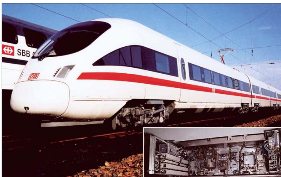
ICE-T mit Bremssteuergeräten in Unterflur-Containerbauweise von Knorr Bremse
