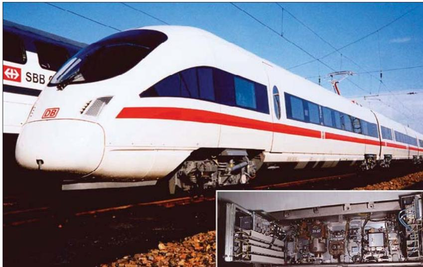
ICE-T mit Bremssteuergeräten in Unterflur-Containerbauweise von Knorr-Bremse
