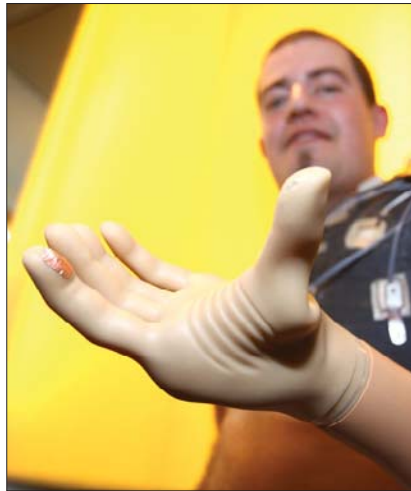
Christian Kandlbauer kann mit einer künstlichen Hand jetzt die Temperatur fühlen, raue und glatte Oberflächen unterscheiden und die Kraft eines Händedrucks spüren.
