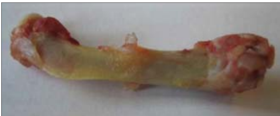
Knochen mit Magnesium-Implantatstift vor Ausstoßversuch (aus Bakkalaureatsarbeit Gerald Holzlechner TU Wien)
