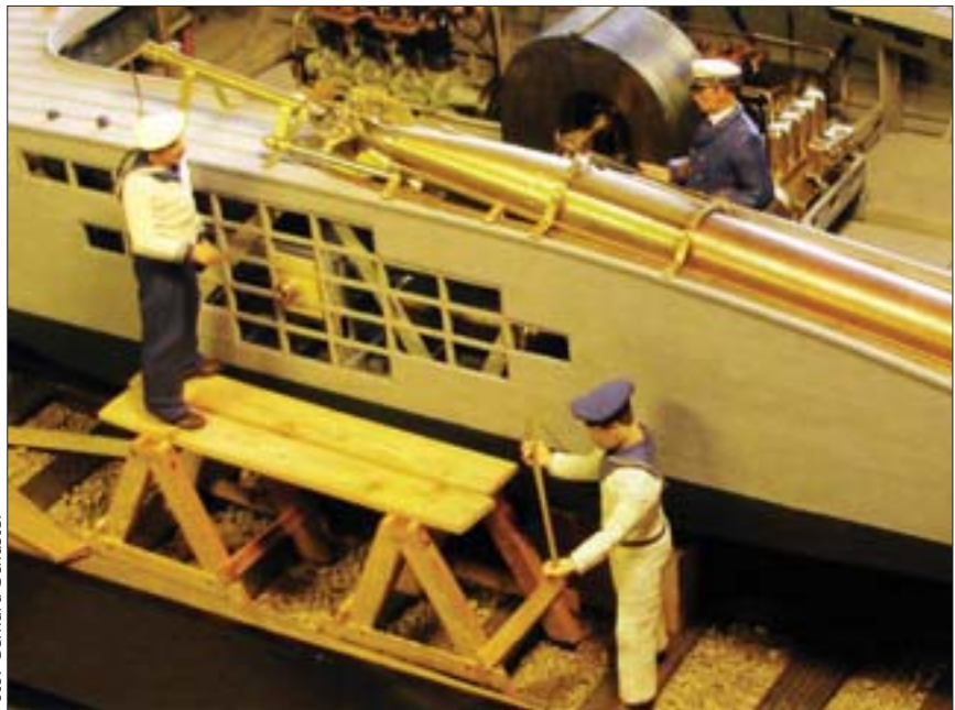
Die geöffneten Seitenplanken geben den Blick auf die filigrane Unterkonstruktion und das Innenleben des Modells frei.
