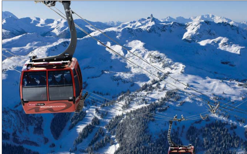
Bis zu 2050 Personen pro Stunde und Richtung werden mit 28 Gondeln transportiert.
