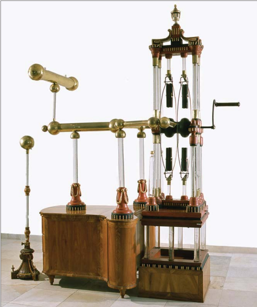
Scheibenelektrisiermaschine, angefertigt von Johann Jechl nach Anleitung des Jesuitenpaters Franz Xaver Racher, Linz-Krummau 1794; Oö. Landesmuseen
