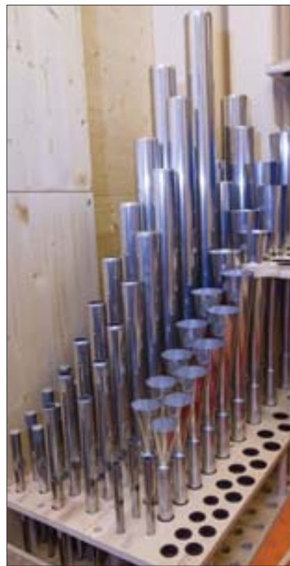
Pfeifen werden in die Windlade gesetzt.
