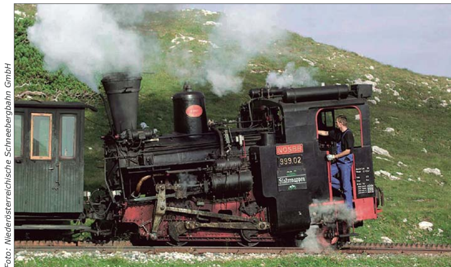
Kessel und Führerhaus sind stark nach vorne geneigt, damit sie in der Steigung annähernd waagrecht stehen. Genau bei 120 Promille ist dies der Fall.
