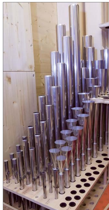
Pfeifen werden in die Windlade gesetzt.
