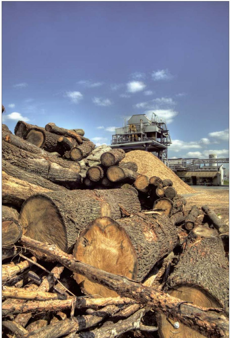
*Durchforstungsholz wird zerkleinert und dann dem Biomassekraftwerk zugeführt.*
