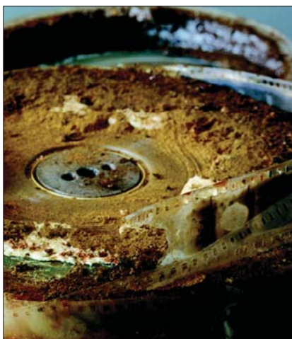
Durch autokatalytischen Zersetzungsprozeß wird aus Filmrollen braunes Pulver.
