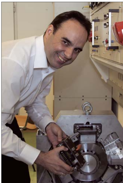
Alexander Schulz wechselt den Magneten des Schwungrades aus
