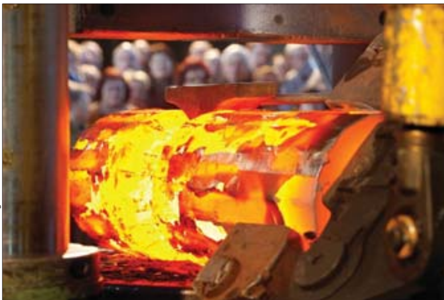
Der Klöppel unter der Schmiedepresse bei Edelstahl Rosswag im badischen Pfinztal
