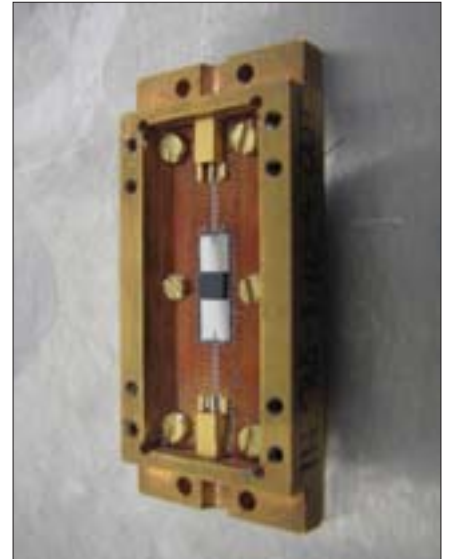
Der Quantenchip: In der Mitte ist der gewundene Mikrowellenresonator und der dunkle Diamant zu erkennen.
