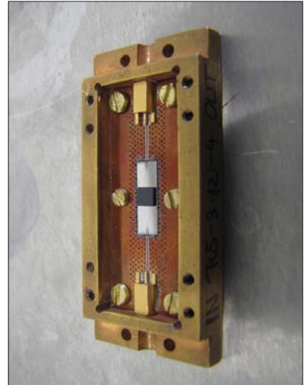
Der Quantenchip: In der Mitte ist der gewundene Mikrowellenresonator und der dunkle Diamant zu erkennen.
