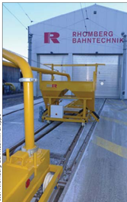
Der Einbaufertiger ist dafür konzipiert, exakte Mengen von Beton im Top-Down-Einbauverfahren abzugeben
