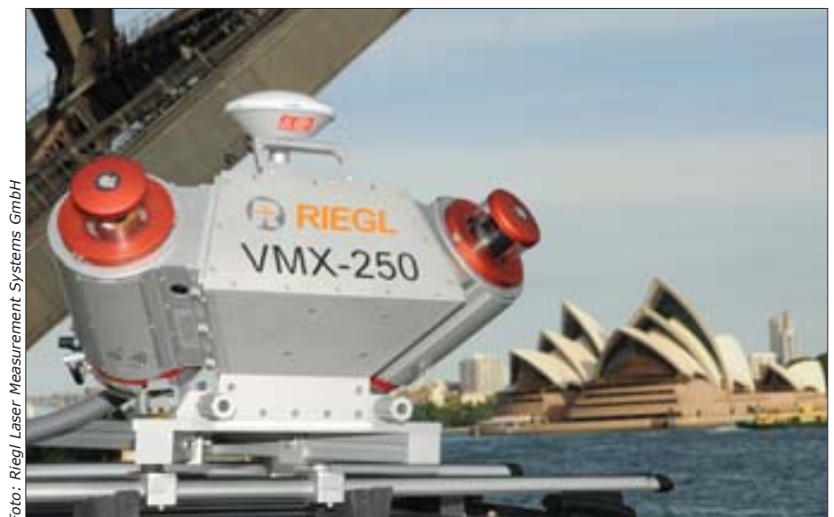
Mobile Laserscanning Systems Riegl VMX-250, auf einem Boot montiert, bei der Datenaufnahme im Hafen von Sydney, Australien
