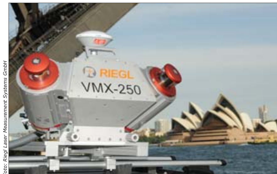
Mobile Laserscanning Systems Riegl VMX-250, auf einem Boot montiert, bei der Datenaufnahme im Hafen von Sydney, Australien
