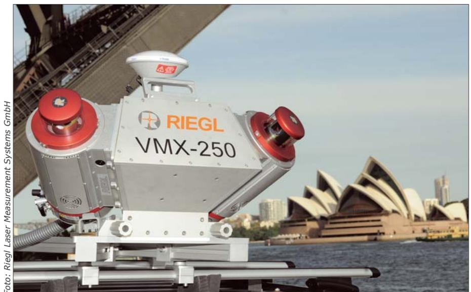
Mobile Laserscanning Systems Riegl VMX-250, auf einem Boot montiert, bei der Datenaufnahme im Hafen von Sidney, Australien
