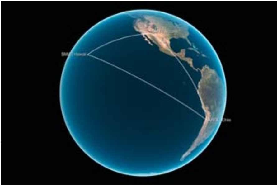
Positionen der drei an dem 1,3-mm-VLBI-Experiment beteiligten Radioteleskope: Die Basislinie zwischen Chile (APEX) und Hawaii (SMA) beträgt 9447 km, zwischen Chile und Arizona (SMT) 7174 km und zwischen Arizona und Hawaii 4627 km.
