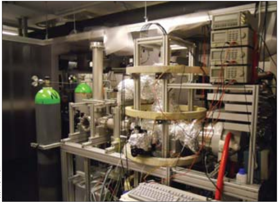
Apparatur für die Vermessung der im Laserpuls erzeugten Molekülfragmente
