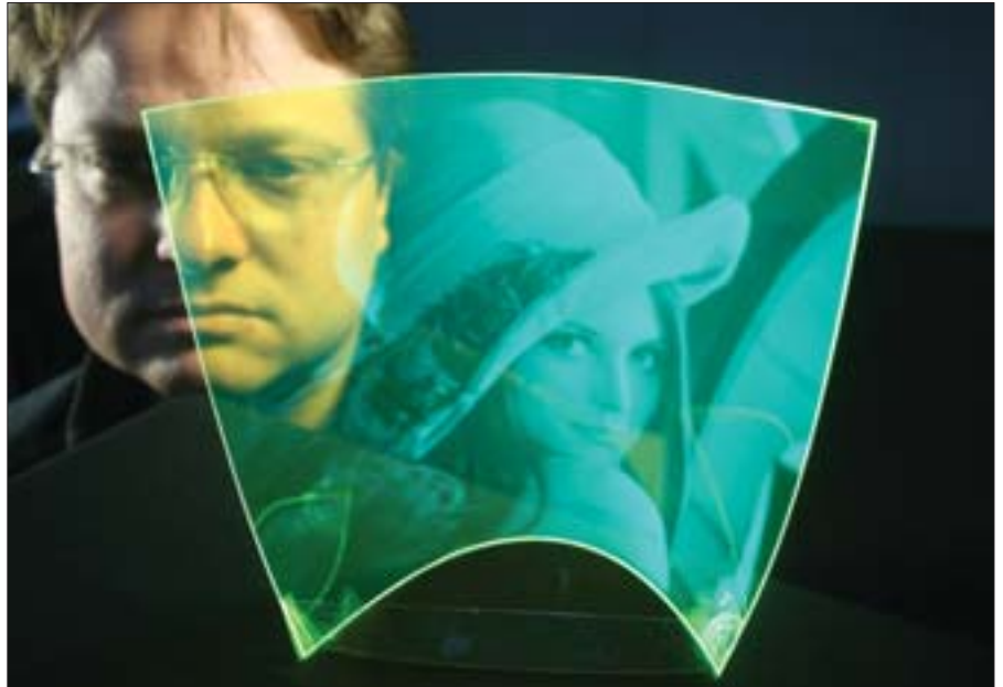
Der weltweit erste biegbare und völlig transparente Bildsensor besteht aus einer mit fluoreszierenden Partikeln dotierten Kunststoffolie.
