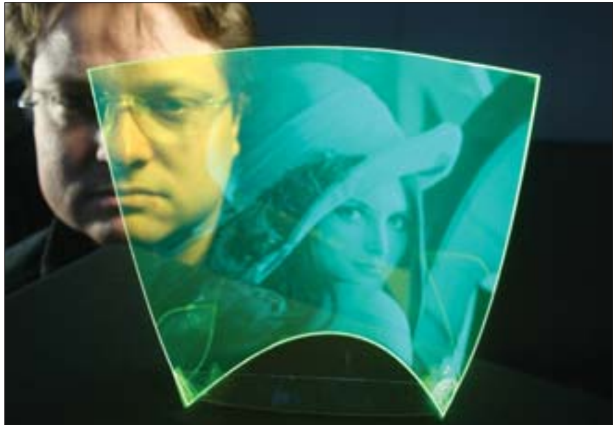
Der weltweit erste biegbare und völlig transparente Bildsensor besteht aus einer mit fluoreszierenden Partikeln dotierten Kunststoffolie.
