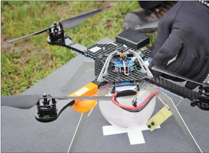
Die AscTec Hummingbird Quadcopter sind klein, agil, robust und mit eigens entwickelten GPS Modulen ausgestattet, sind sie sehr präzise zu steuern.
