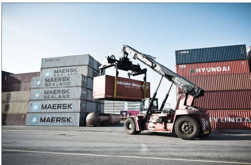
Insgesamt 13 Containerstapler mit einer Hubkraft von je bis zu 45 Tonnen kommen im WienCont-Terminal zum Einsatz.
