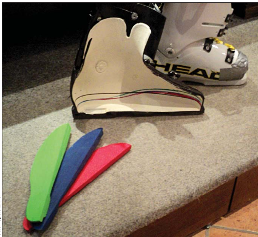
Querschnitt durch einen Skischuh. Drei in ihrer Höhe verschieden ausgebildete Einlagen (Module) bewirken unterschiedliche Positionen und verändern damit das Fahrverhalten.
