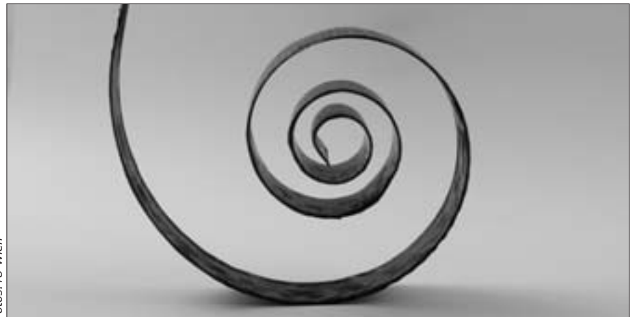
oben: Schraubendruckfeder unten: Spiralfeder
