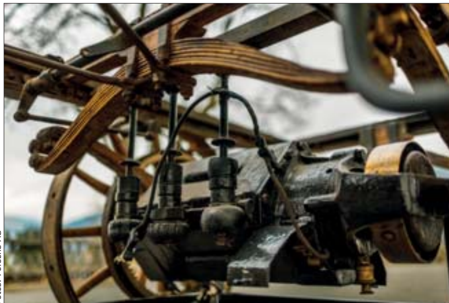
Die Leistung des sehr kompakten und nur 130 kg schweren Elektroantriebs: 3 PS
