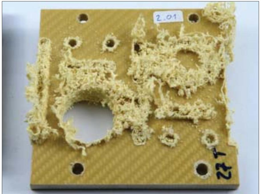
Bild oben: Unbrauchbares Ergebnis mit herkömmlichen Methoden
