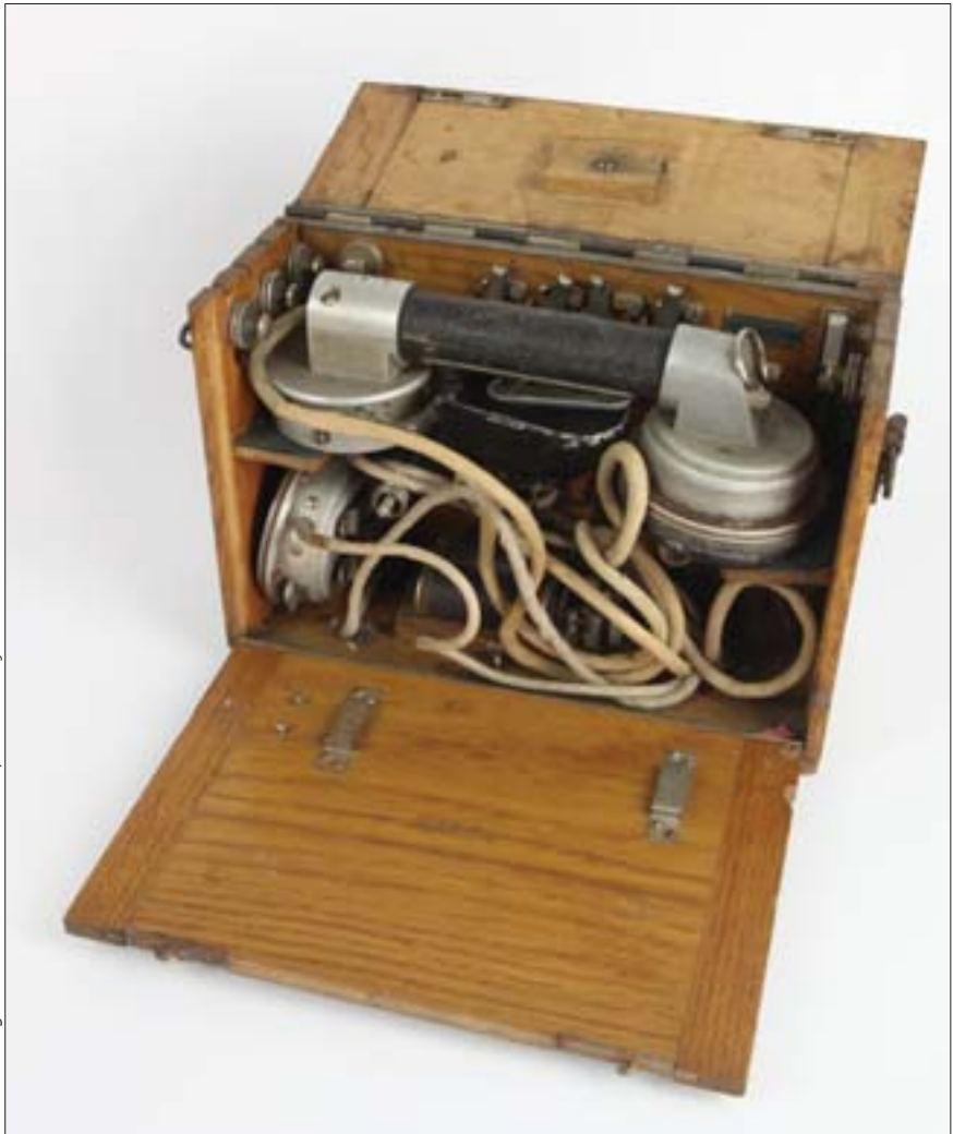
K. u. K. Feldtelefon: Mikrofonkassette M 1907 einer Telefonstation samt Batteriekasten
