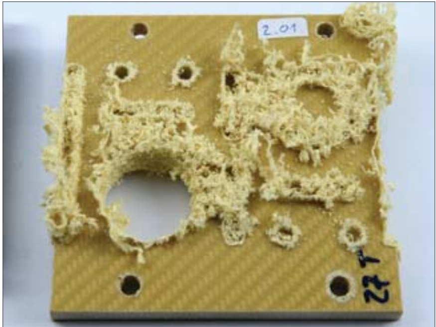
Bild oben: Unbrauchbares Ergebnis mit herkömmlichen Methoden Bild unten: Sauberes Ergebnis mit Fibrecut-Methoden
