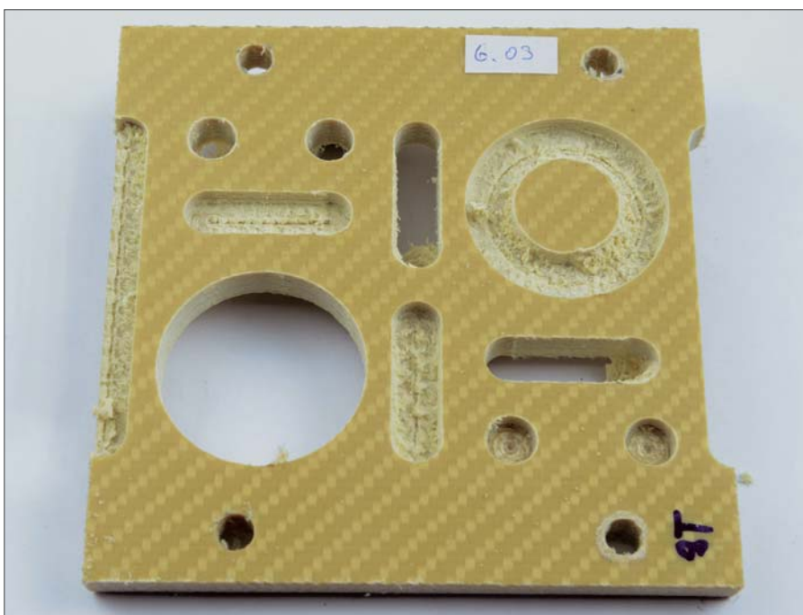
Bild oben: Unbrauchbares Ergebnis mit herkömmlichen Methoden Bild unten: Sauberes Ergebnis mit Fibrecut-Methoden
