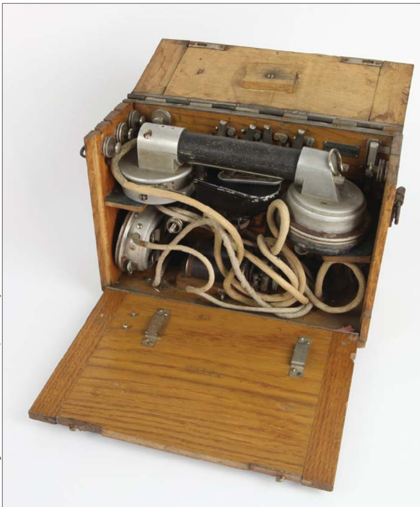
K. u. K. Feldtelefon: Mikrofongkassette M 1907 einer Telefonstation samt Batteriekasten
