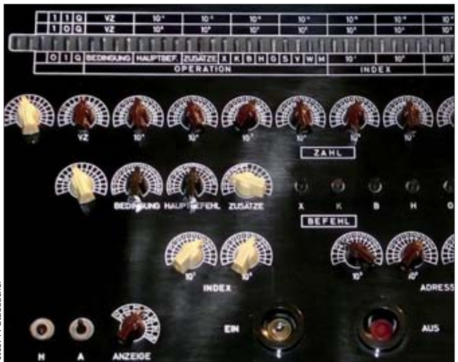
Das Schaltpult des »Mailüfterls«, eines der weltweit ersten Computer, die mit Hilfe von Transistoren funktionierten.
