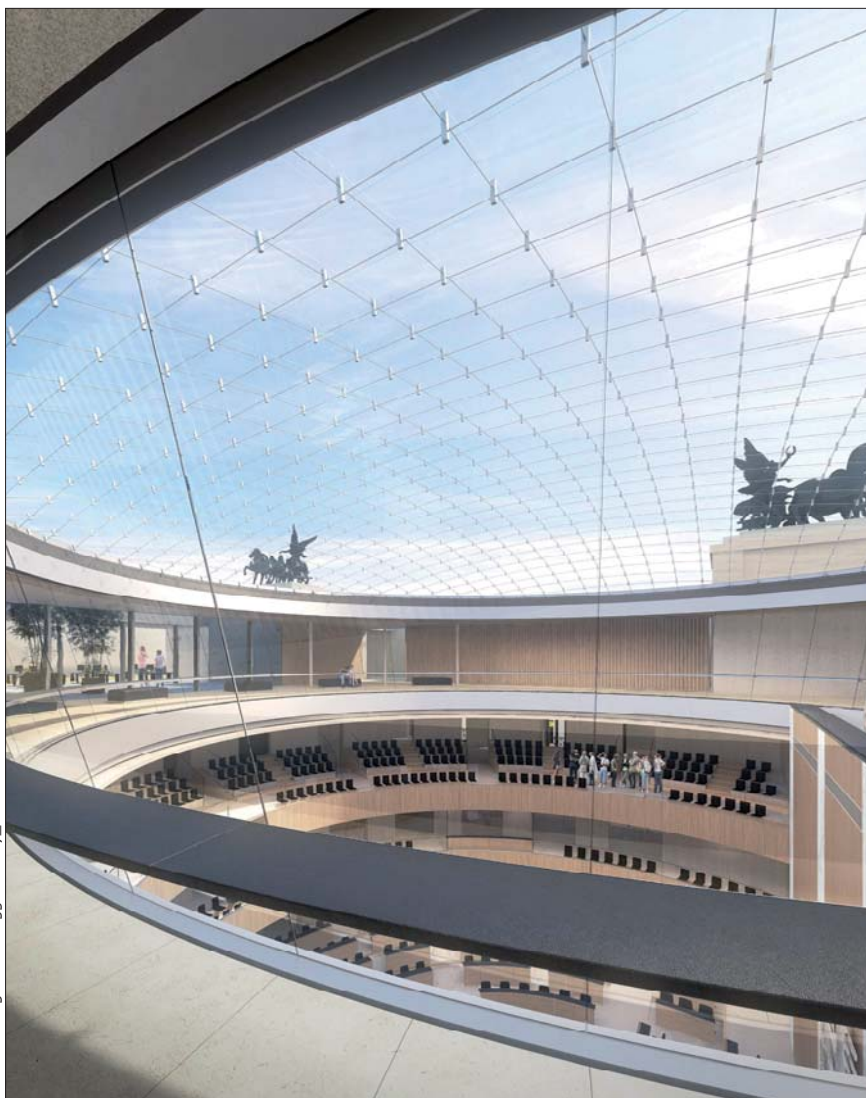
Das Dach über dem Nationalratssaal besteht aus einer frei tragenden Glaskugelkalotte und einem die Kalotte unterstützenden Stahlträgerrost.
